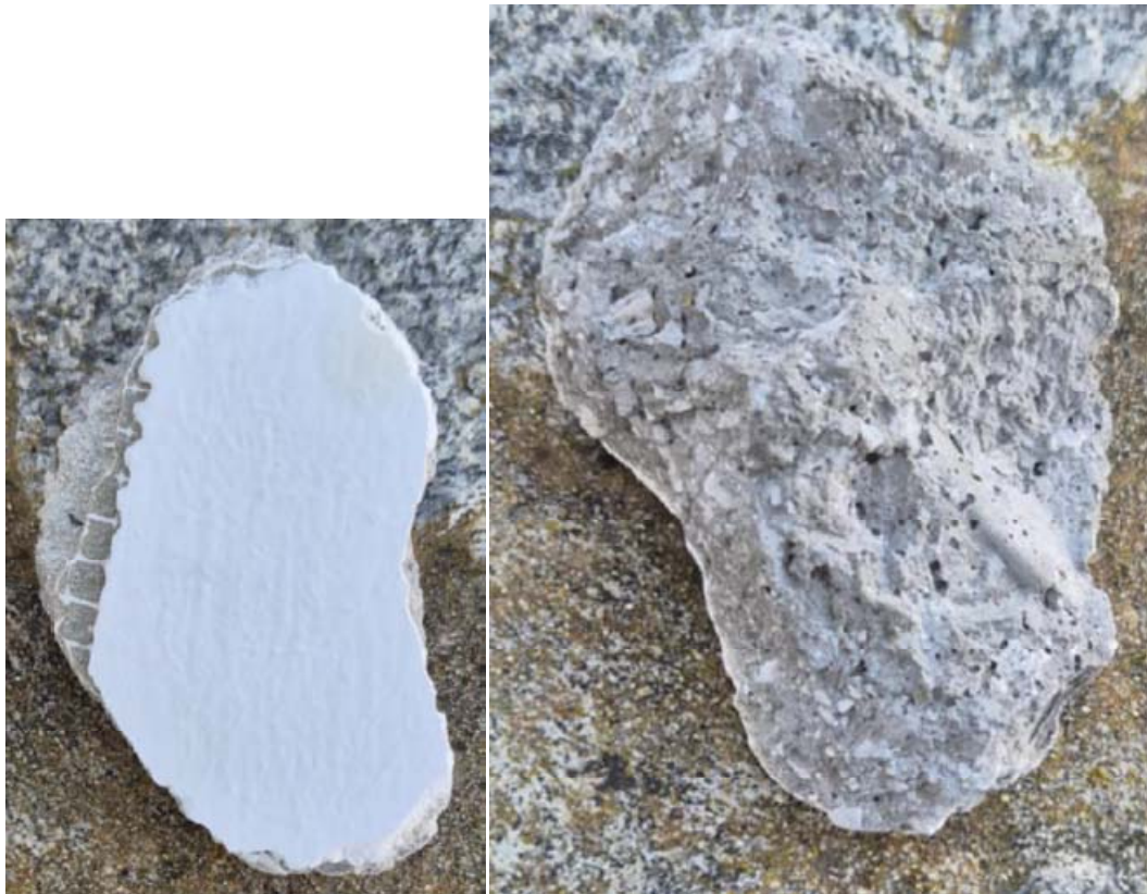
Slika 11: Finozrnata struktura odbitega dela velikosti cca. 9 x 5 cm
